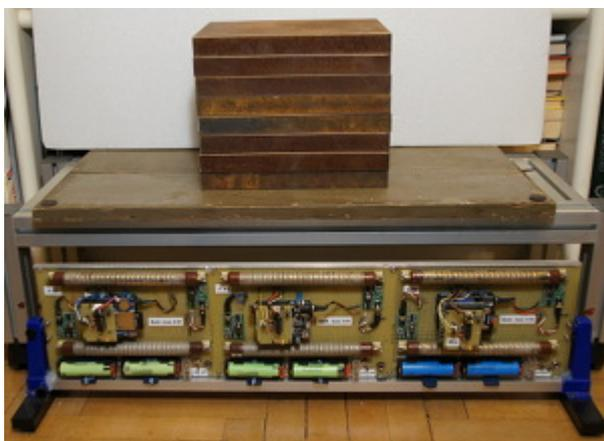
[2] Nella foto si nota l'oggetto da muografare formato da otto piastre di Fe sovrapposte a formare un cubo, ed il portale che le sorregge fatto di profilati commerciali di Al e dotato di ruote per poterlo far scorrere lungo il percorso stabilito.
