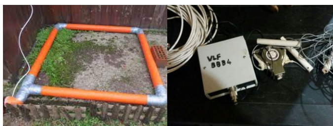
fig 4 - antenna LOOP (sinistra) e ricevitore VLF (destra)
