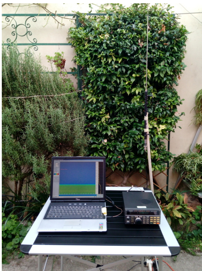
Fig 5 - Esempio di set-up per meteor scatter
