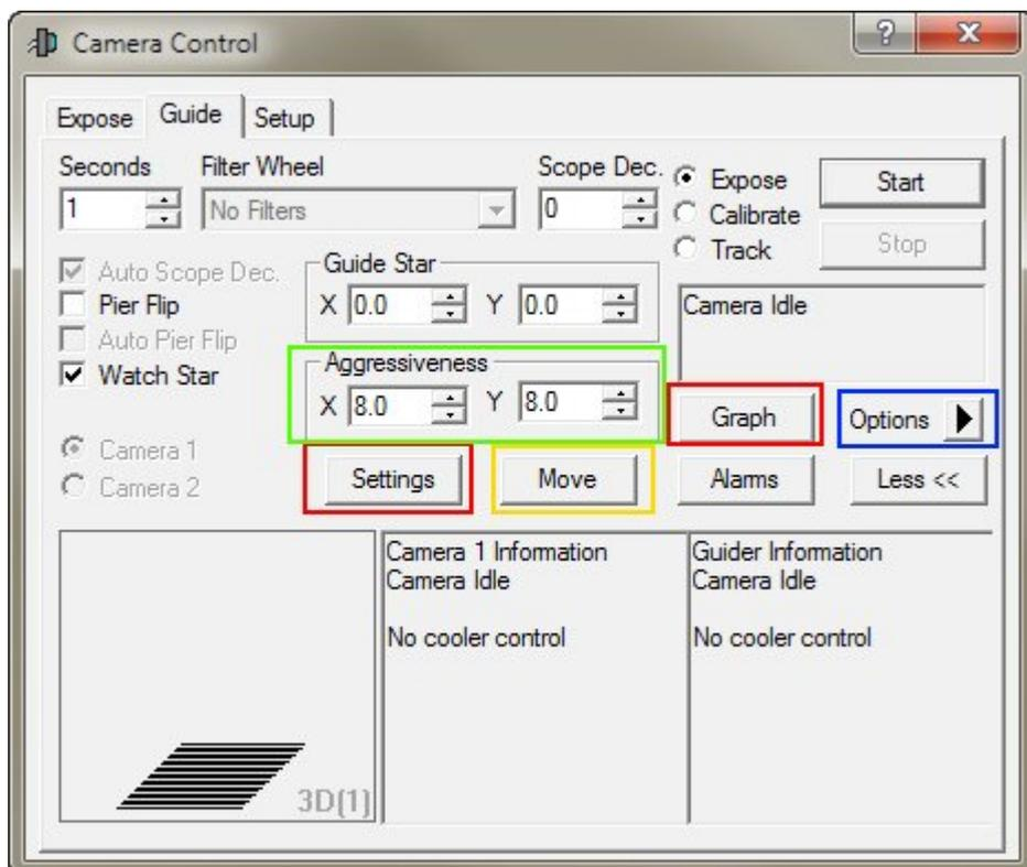
Si inizia con l'istruire la camera di guida che controlla la montatura. Per fare questo premere il pulsante ?Settings?. Si accede ad un altro pannello dove si configura la camera di guida.
