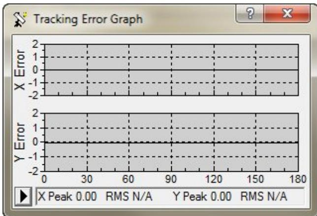
Molte volte bisogna intervenire sui parametri di aggressività per aggiustare la guida nel migliore modo possibile, è necessario modificare questi valori in modo indipendente per ogni asse. L'aggressività è in breve "l'energia" con cui il sistema corregge gli errori di inseguimento.
