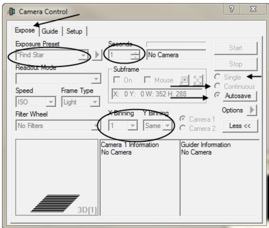
Nella parte <Exposure Preset> sono memorizzate delle impostazioni predefinite come: Focus ,Focus Guider, Find star, Find DSO, Image ecc. Questi preset sono comunque modificabili a piacere; inoltre è possibile creare altri ?preset?a seconda delle nostre particolari esigenze. Per ese
