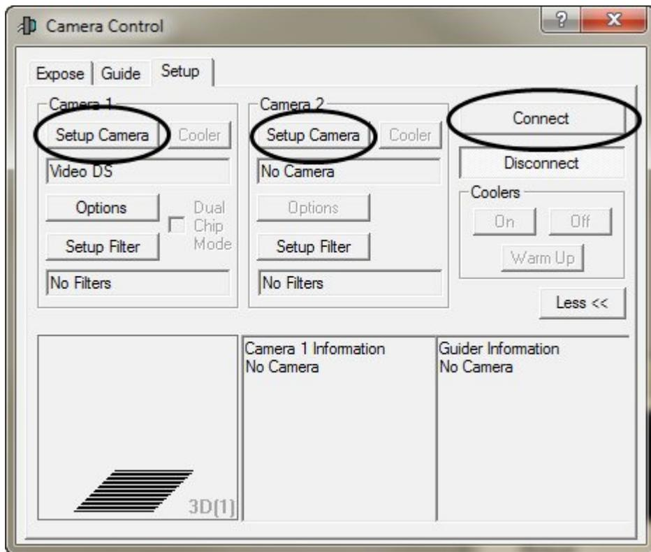
Per configurare la camera CCD selezionare il tab <Setup>. La finestra di controllo dovrebbe apparire come quella di figura 2.
