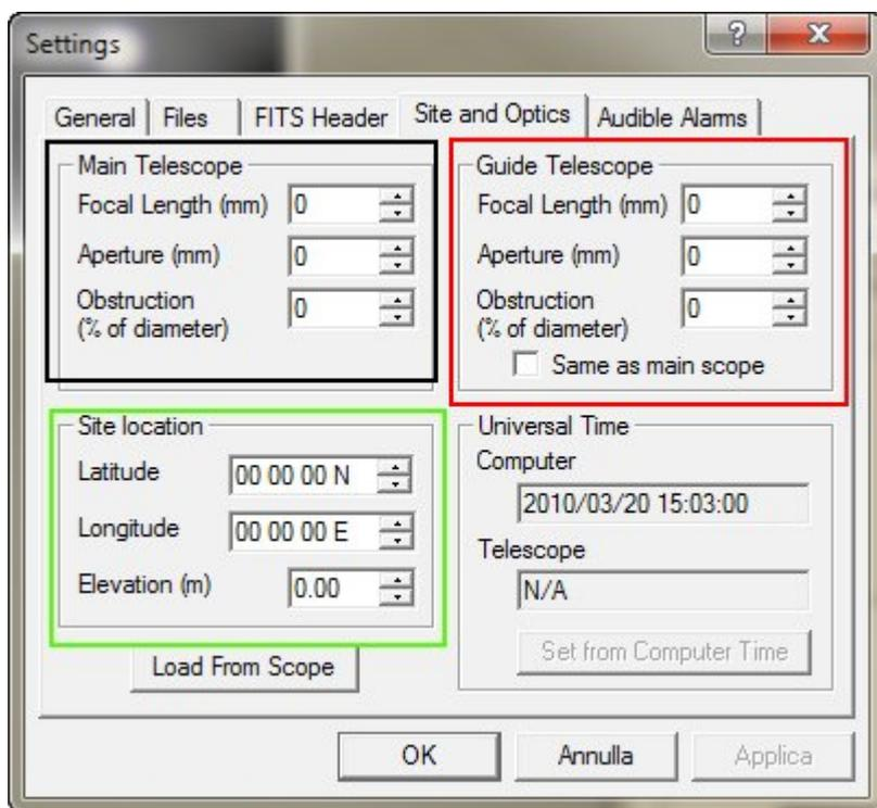
Nella sezione bordata di nero (nella figura) inserire i dati del vostro telescopio principale. Nella sezione rossa il telescopio di guida, se si usa lo stesso telescopio principale anche come guida (per esempio se avete una CCD con il doppio sensore o se usate una guida fuori asse) spuntare la voce <Same as main scope>
