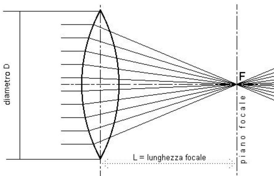
Questi due parametri sono caratteristici di ogni strumento, vengono stabiliti in fase di costruzione e determinano il funzionamento del nostro telescopio. Combinati insieme esprimono il **Rapporto Focale**
