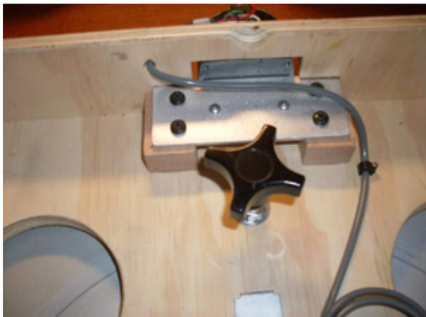
La frizione ed il motore in azimuth
