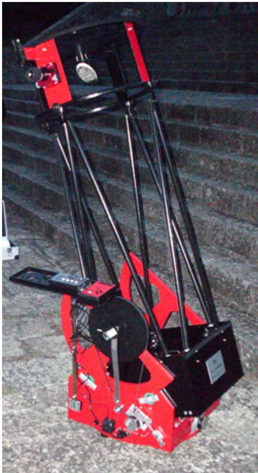
Da allora non l'ho più modificato, l'ho solo verniciato per renderlo più elegante?: cosa si può pretendere di più per l'osservazione visuale? E' uno strumento che si smonta e una persona lo può gestire e trasportare in un'auto media, si monta in pochi minuti, ha un sistema di puntamento passivo che non sbaglia un colpo ed ora ha anche dei motori che, usati a dovere, tengono gli oggetti nel campo anche a 200/300 ingrandimenti.
